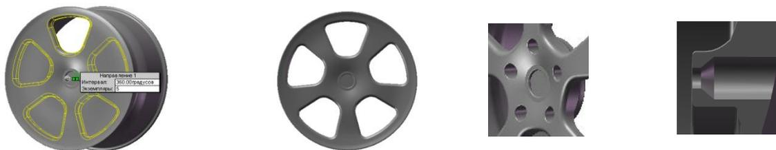
Рис. 15. Этапы моделирования диска колеса
