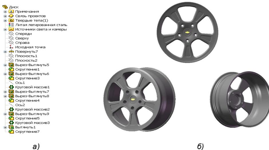
Рис. 16. Дерево конструирования (а) и диск колеса (б)
